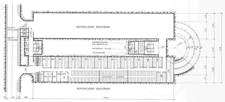
Bild 4. Querstollen, Untergeschoss 1:600, eingerichtet als Sanitätshilfsstelle und Schutzraum
