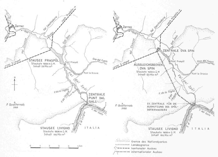
Bild 15. Wasserkraftnutzung des Inn und seiner Seitenbäche. Einzelheiten betreffend das Spölgebiet, 1:120 000. Links Projekt 1955 mit Stausee Praspöl, rechts Projekt 1957 (abgeändert 1958) mit Ausgleichsbecken Ova Spin (Verständigungslösung)
