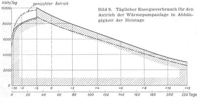
stark aufwärmen muss. Bei zweckmässiger Bauausführung sind die Wärmeverluste über Nacht gegenüber unterbrochenem Betrieb nur wenig grösser und werden durch den besseren Wirkungsgrad des gleichmässigen Betriebs wieder ausgeglichen.
