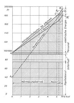
Bild 11. Jahreskosten einer Wärmepumpanlage mit Spitzendeckung durch oelgefeuerte Kessel in Abhängigkeit der erzeugten Wärme bei zwei verschiedenen Strompreisen. Gestrichelt die Jahreskosten einer Vergleichsanlage mit oelgefeuerten Kesseln.
