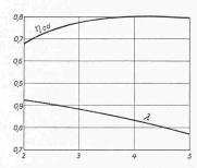
Bild 7. Wirkungsgrad gegenüber adiabatischer Verdichtung und Liefergrad des Kompressors
