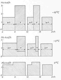
Bild 4. Heizprogramme für mittl. Tagestemperaturen von -10, -5 und  $0^{\circ}$  C. WP = Wärmepumpbetrieb, K = Kesselbetrieb, M = gemischter Betrieb
