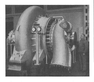
Speicherpumpen in Ausführung: Gougra-Motec: 628 m, 30800 PS
