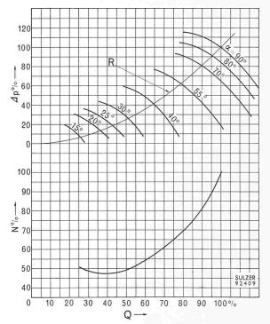
Bild 14. Charakteristiken eines CO<sub>2</sub>-Gebläses
