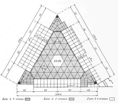
Anordnung der Trägeraxen im mittleren Boden (Kote  $\pm$  12 m, Dreiecknetz) und in den Seitenbauten (Rechtecknetz, vier Geschosse). Masstab 1:3000
