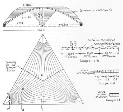
Ansicht und Grundriss 1:3000, Vertikalschnitte der Dachschale rd. 1:1200
