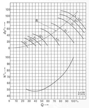
Bild 14. Charakteristiken eines CO<sub>2</sub>-Gebläses
