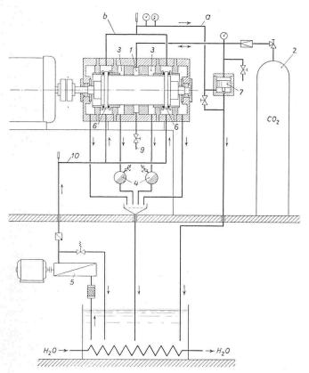
Bild 10. Versuchsvorrichtung für drehende Dichtungen
