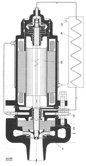
Bild 2. Schwerwasser-Pumpe mit gekapseltem Motor für 125 ata und 220  $^{\circ}$  C. Die Pumpe ist vom Motor durch eine thermische Sperre getrennt
