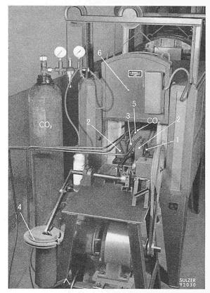
Bild 12. Versuchsstand für die Untersuchung der Trockenreibung im Steuermechanismus der drehbaren Vorleitschaufeln
