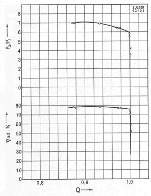
Bild 8. Charakteristiken eines radialen Ueberschall-Kompressors für Freon 12
