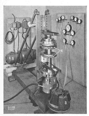
Bild 7. Versuchsvorrichtung für axiale gasgeschmierte Lager
