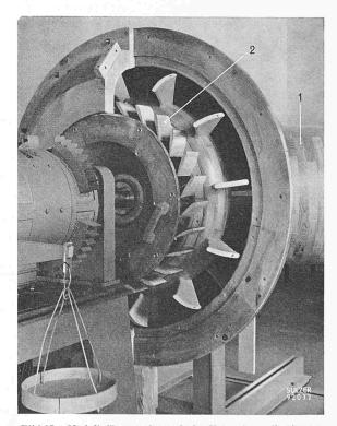
Bild 13. Modell für aerodynamische Versuche, teilweise geöffnet 1 Saugleitung 2 drehbare Vorleit-Schaufeln
