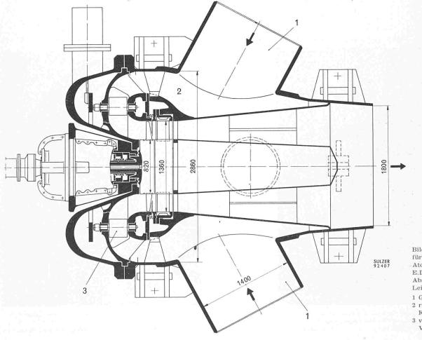
Bild 9. CO<sub>2</sub>-Gebläse für die französische Atomzentrale E.D.F. 1-Chinon, Absorbierte Leistung 9000 kW
