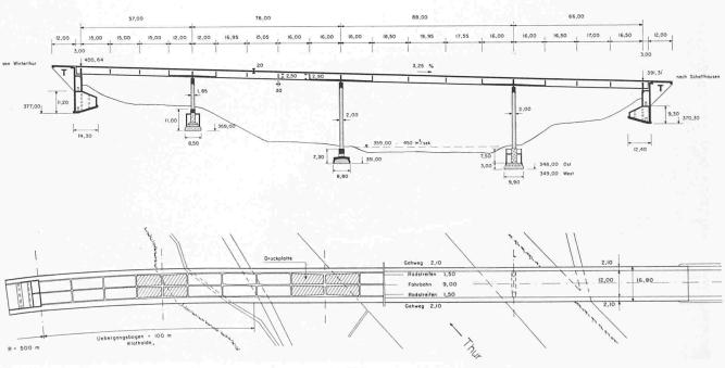
Grundriss und Längsschnitt der Weinlandbrücke, Masstab rd. 1:2000
