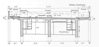
Querschnitt in Feldmitte, Masstab rd. 1:200
