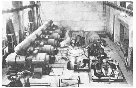
Fig. 2. Centrale de Tours de 5500 kW avec générateurs à pistons libres, chambre de postcombustion et turbine à gaz
