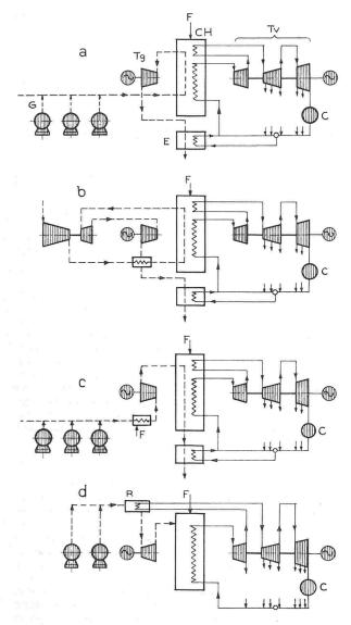
Fig. 1. Groupe combiné gaz-vapeur pour production d'énérgie électrique
