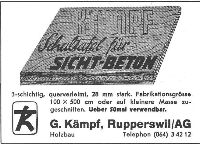
3-schichtig, querverleimt, 28 mm stark. Fabrikationsgrösse 100 × 500 cm oder auf kleinere Masse zugeschnitten. Ueber 50mal verwendbar.
