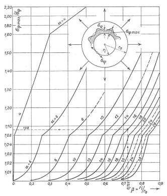
Bild 3. Verhältnis von maximaler zu mittlerer Tangentialspannung am innern Radius einer Kreisringscheibe in Abhängigkeit vom Radienverhältnis  $\beta=r_i/r_a$  mit Anzahl Einzellasten  $\alpha$  als Parameter.
