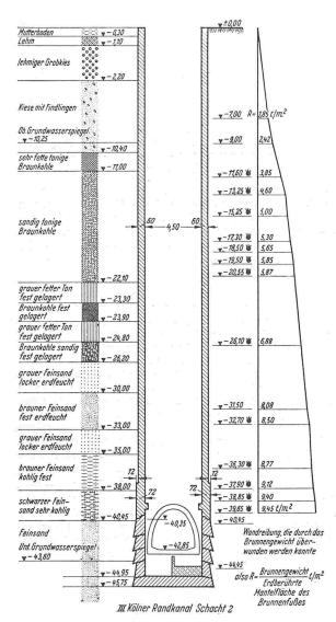
Bild 3. Schachtbrunnen von etwa 40 m Tiefe und 4,5 Durchmesser bei einem Stollen des Kölner Randkanals, gebaut durch die Firma Wayss und Freytag
