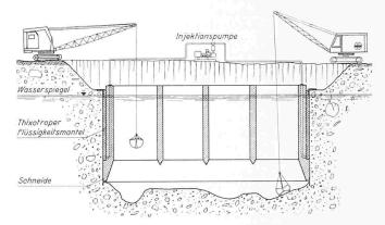
Bild 5. Die Baugrube mit abgeteuftem Kasten
