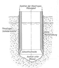
Abteufen mit Hilfe thixotroper Flüssigkeiten
