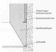
Bild 2. Ausbildung der Schachtschneide mit Dichtungsmembrane aus Gummi
