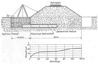
Bild 13. Horizontale Unterdückung der Emmental - Burgdorf - Thun - Bahn. Durchmesser der Zementrohrleitung 60 cm. Bauunternehmung: AG. für Grundwasserbauten, Bern; Masstab 1:250
