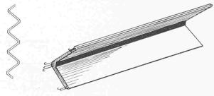
Silo in Rabat-Salé, vorfabriziertes Horizontalelement aus Eisenbeton, rd. 2 m lang (links Vertikalschnitt der Wand)
