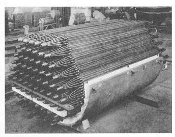
Bild 4. Wärmeaustauscher mit Doppel-Wellbandrippenrohren während des Zusammenbaues
