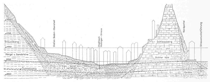
Bild 4. Neuer Bahntunnel, geologisches Längsprofil; Längen 1:4000, Höhen 1:800
