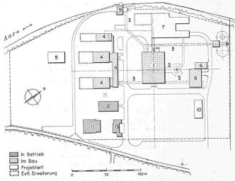
Bild 1. Lageplan der Würenlinger Reaktoranlagen
