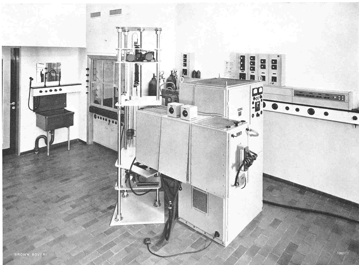
Bild 22. Physikalisches Laboratorium (207) mit Kristallziehapparatur
