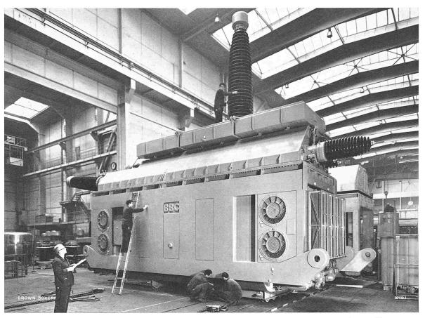
Bild 2. Einphasen-Wandertransformator: Durchgangsleistung in Sparschaltung 660 000:3 kVA,  $400:\sqrt{3}/231:\sqrt{3}$  kV, 50 Hz mit Ausgleichwicklung 200 000:3 kVA, 30 kV. Regulierung der Mittelspannung unter Last um  $\pm$  18% durch eingebauten Stufentransformator
