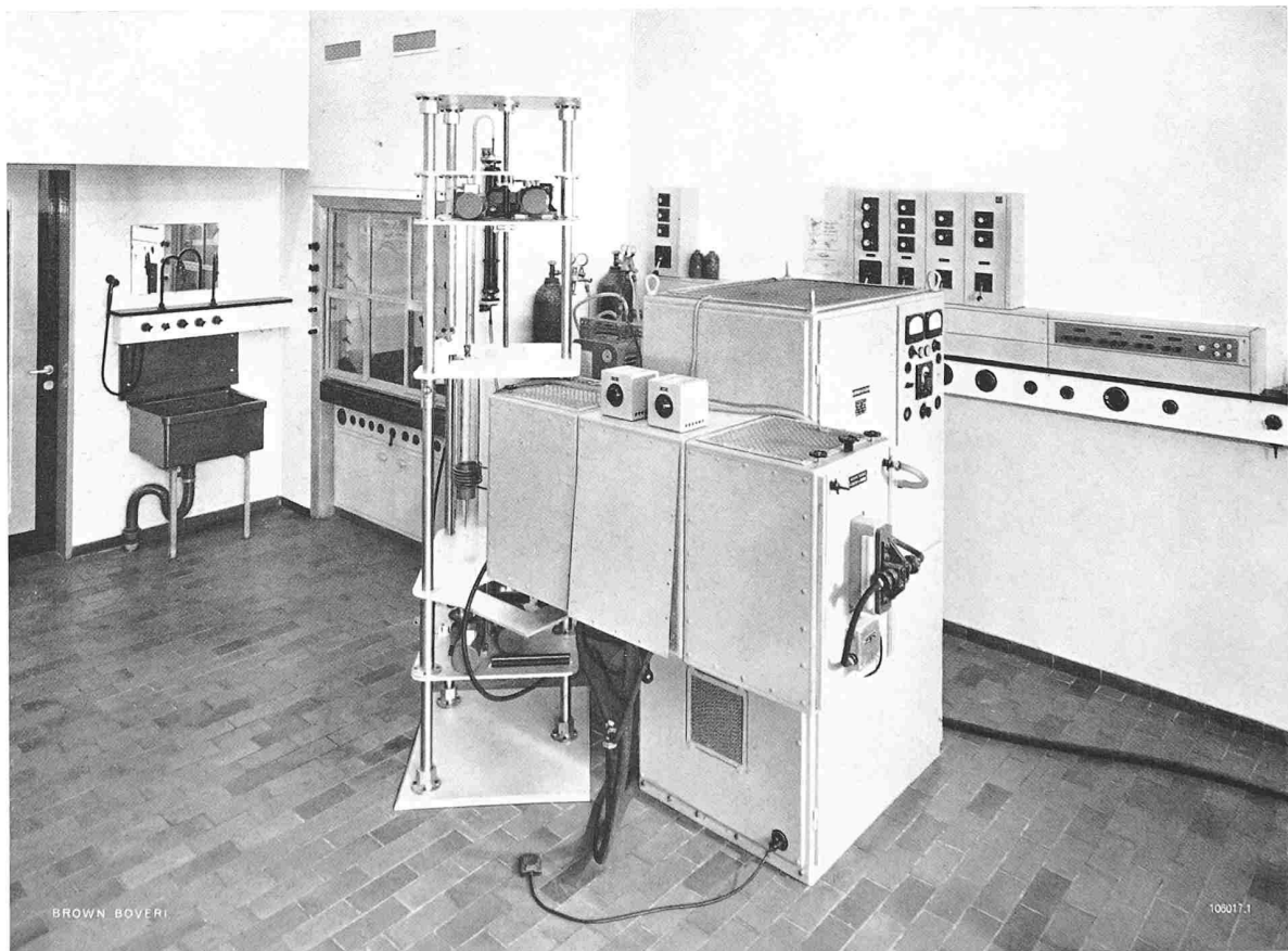
Bild 22. Physikalisches Laboratorium (207) mit Kristallziehapparatur
