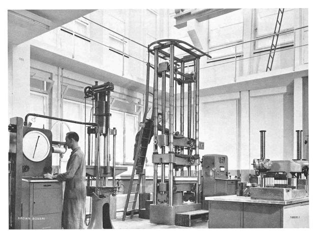
Bild 21. Die Zerreissmaschinen im Festigkeitsprüfraum
