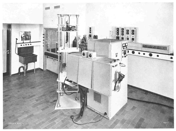
Bild 22. Physikalisches Laboratorium (207) mit Kristallziehapparatur
