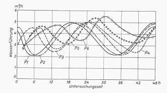
Bild 3 (links). Die Schwankung der Wassermenge, d. h. der natürlichen Wasserführung und des zugeführten Abwassers, an den verschiedenen Probequerschnitten während einer der Untersuchungen
