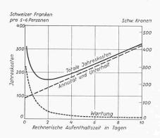
Bild 9. Berechnete Jahreskosten für Abwasserfaulkammern als Funktion der rechnerischen Aufenthaltszeit, sowohl insgesamt als auch verteilt auf einerseits Zinsen, Amortisation und Unterhalt und anderseits auf Wartungskosten (Entleerungskosten)
