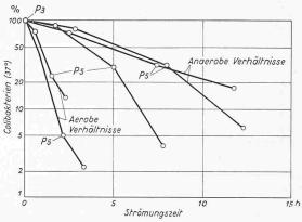
Bild 7. Bakterienreduktion mit der Strömungszeit bei den fünf Untersuchungen im Jahre 1953, angegeben in Prozent der Colibakterienmenge bei  $P_3$
