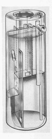
rig sitzenden Oeffnung 5 zum Fach II im Fach I eine Kombination von aufwärtsgerichteter und abwärtsgerichteter Strömung entsteht. Hiedurch wird gemäss dem vorher Gesagten ein guter volumetrischer Wirkungsgrad im ersten Fach und ebenso in den folgenden - erzielt, unabhängig vom Verhältnis der Temperatur des einströmenden Abwasssers zu derjenigen im Faulraum.
