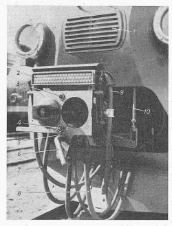
Bild 2. Automatische Mittelpufferkupplung, Typ Scharffenberg
