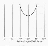
Bild 10 a und b. Relative Kosten von Abwasserfaulkammern pro kg entzogener Verunreinigung, links in Funktion der rechnerischen Aufenthaltszeit, rechts in Funktion des Behandlungseffektes
