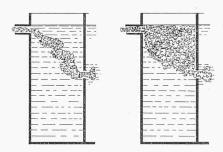
Bild 11. Strömungsverhältnisse in einer Modellkammer. Links einströmendes Wasser kälter als Behälterwasser, rechts umsgekehrt. Einlauf links oben, Auslauf rechts auf halber Höhe
