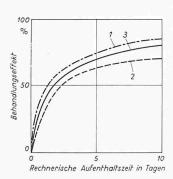
Bild 8. Gemessene Abnahme der organischen Verunreinigung bei veränderlicher rechnerischer Aufenthaltszeit im Durchschnitt für die drei Abwasserfaulkammern der Versuchsanlage im Jahre 1953. 1. Gemessener biochemischer Sauerstoffbedarf (BSB), 2. Gemessener Permanganatverbrauch (KMnO4), 3. Angenommene Mittelwerte für die Reduktion der organischen
