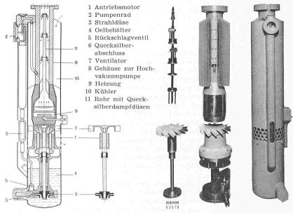
Bild 1. Die Oerlikon-Hochvakuum-Strahlpumpe
