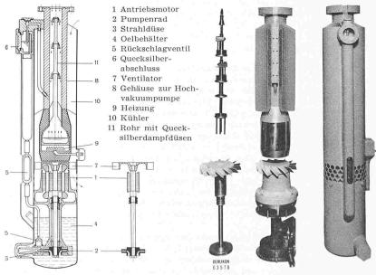
Bild 1. Die Oerlikon-Hochvakuum-Strahlpumpe
