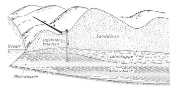
Bild 11. Schematischer Schnitt senkrecht zur Brunnenreihe im Endzustand nach langjähriger steter Süsswasserinjektion
