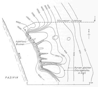
Bild 12. Lageplan der versuchsmässigen Brunnenreihe mit den Kurven gleichen Chloridgehaltes nach 18 Monaten anhaltender Süsswasserinjektion
