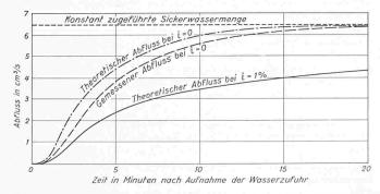
Bild 2. Vergleich der theoretischen und experimentellen Abflussmengen an der Austrittsfläche während der Wachstumsphase eines Stauhügels auf waagrechtem und geneigtem Grundwasserspiegel
