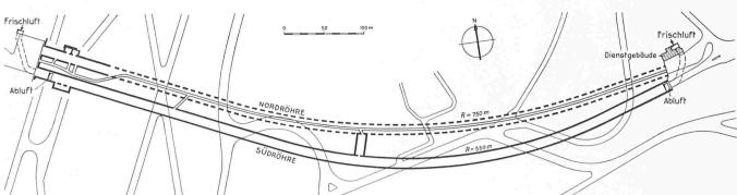
Bild 1. Längsschnitt und Lageplan des 824 m langen Wagenburgtunnels in Stuttgart, 1:5000
