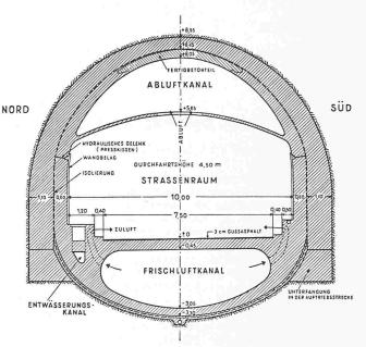
Bild 3. Querschnitt 1:175 durch die Südröhre mit Querlüftung
