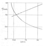
Bild 8 (links). Voraussichtliche Gestehungskosten für elektrische Energie aus K-Werken (ausgezogen) und aus B-Werken (gestrichelt)
