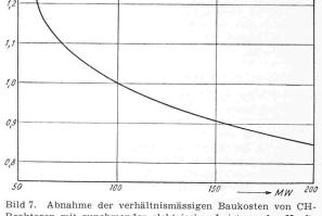
Bild 7. Abnahme der verhältnismässigen Baukosten von CH-Reaktoren mit zunehmender elektrischer Leistung des Kraftwerks pro Kernreaktor.
