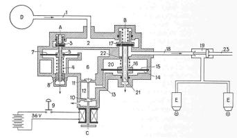
Bild 8. Funktionsschema der Schleuderbremse Brown, Boveri-Charmilles
