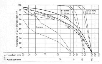
Bild 1. Streuungsbereiche der drei lieferbaren Komponenten eines gut eingerichteten zürcherischen Kieswerkes. Gefährlich ist die grosse Schwankung der Komponenten  $0 \div 8$  mm. Gewichtsmässige Dosierung der Zuschlagstoffe ist für Qualitätsbeton, und sei es mengenmässig noch so wenig, notwendig
