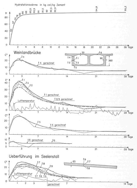
Bild 7. Gemessene und geschätzte (nach Voellmy) Temperaturen in einem Kastenquerschnitt und bei einer Plattenbrücke
