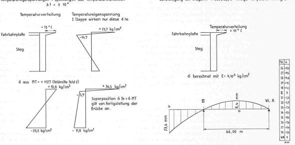
Bild 5. Einfluss einer ungleichmässigen Temperaturbeanspruchung bei einem durchlaufenden Balken
