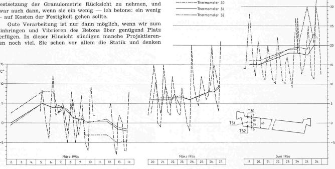
Verlauf der Betontemperaturen an drei Stellen einer 63 cm starken Plattenbrücke Bild 4.
