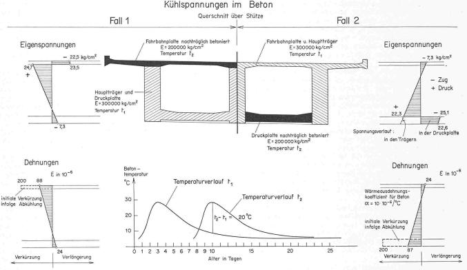
Bild 6. Durch die Wahl eines geeigneten Bauvorganges können die Beanspruchungen infolge Abbindetemperaturen wesentlich beeinflusst
