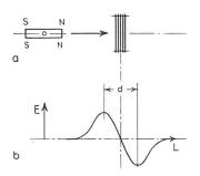
Bild 2a (links). Stabmagnet, der sich mit gleichförmiger Geschwindigkeit durch eine Einzelspule verschiebt
