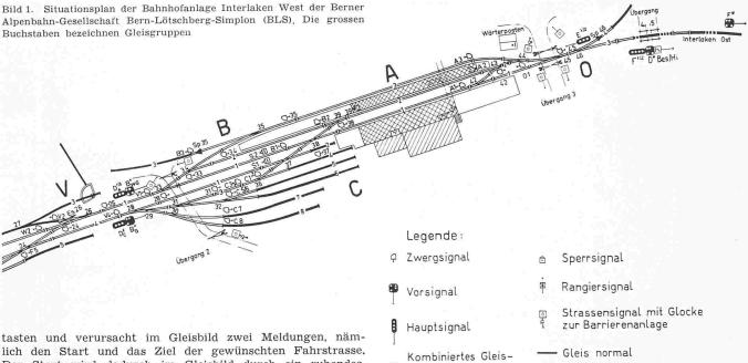
tasten und verursacht im Gleisbild zwei Meldungen, nämlich den Start und das Ziel der gewünschten Fahrstrasse. Der Start wird dadurch im Gleisbild durch ein ruhendes, das Ziel durch ein blinkendes Licht markiert. Sind mehrere Fahrwege zwischen diesen beiden Punkten möglich, bleibt die Auswahl dem Stellwerkbeamten vorbehalten. Für besondere Fälle ist die Gleismelderanlage ausserdem für Gegensprechverkehr ausgerüstet.
