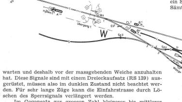
Im Gegensatz zur grossen Zahl kleinerer bis mittlerer Anlagen, in denen die Manöver über unverschlossene Weichen abgewickelt werden, ist der Bahnhof Interlaken West für Rangierbetrieb über verschlossene und überwachte Weichen gebaut. Zu diesem Zweck fanden Zwergsignale (RS AZ ½0) Aufstellung, die folgende Begriffe signalisieren:
