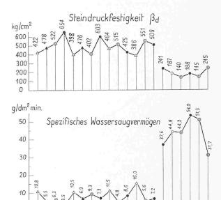
Bild 24. Steindruckfestigkeit und spezifisches Saugvermögen der Backsteine hochwertiger und normaler Qualität. Wohnhochhäuser «Altwyler» in Bern
