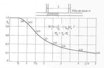
Bild 22. Die Aussteifung durch Zwischenwände steigert die Tragfähigkeit (Tragwand ohne Oeffnungen!)
