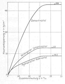
Bild 7 (links). Spannungs-Stauchungsdiagramme für die Mauerwerke mit den drei Mörtelarten: hydraul. Kalkmörtel HK 350, verlängerter Zementmörtel HK 250 + P 100 und Zementmörtel P 300, 1½ Normalsteine mit 289 kg/cm² Steindruckfestigkeit. Zentrische Belastung, Schlankheitsverhältnis 1/d = 20, Mauerstärke: 12 cm, Mauerbreite: 80 cm, Alter 29 Tage
