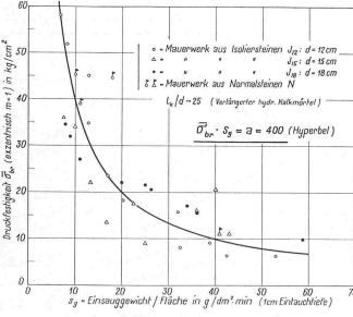
Bild 14. Mit grösserer Saugfähigkeit des Mauersteines nimmt infolge der grösseren Ausbiegung des exzentrisch im Kernrand belasteten Mauerwerkes die Tragfähigkeit rasch ab. Die Versuchspunkte scharen sich um eine Hyberbel
