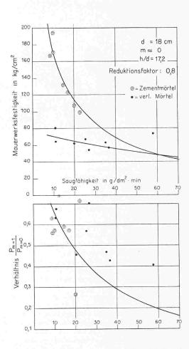
so bald die Steinsaugfähigkeit von 7½ g/dm²min auf über 40 g/dm²min wächst. Die Mauerwerkfestigkeiten nehmen bei zentrischer Belastung erheblich ab; besonders krass ist aber die Abnahme der Tragfähigkeit mit steigendem Saugvermögen bei exzentrischem Lastangriff.
