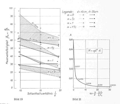
Bild 19 (Mitte). Festigkeit des Einstein- und des Verbandmauerwerkes bei gleichem Schlankheitsverhältnis von 10 bis 20. Verlängerter Zementmörtel, 1½-N-Format, Steindruckfestigkeit: 289 kg/cm². Bei zentrischer Belastung ist das Einsteinmauerwerk überlegen. Mit zunehmender Schlankheit der Versuchswand und ansteigender Exzentrizität des Lastangriffs verschiebt sich die Tragfähigkeit zugunsten des dickeren, relativ exakter hergestellten Verbandmauerwerkes
