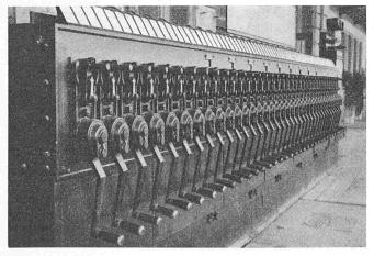
Bild 1. Mechanisches Freigabewerk Schaffhausen, 37 Kurbeln auf eine Länge von  $6{,}80~\mathrm{m}$
