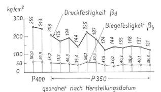
Bild 23. Mörtelfestigkeiten an  $4 \times 4 \times 16$  cm Prismen eingesandt von Baustelle Wohnhochhäuser «Altwyler» in Bern. Sinkende Mörtelfestigkeiten mit abnehmender Beanspruchung des Mauerwerkes
