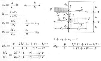
Bild 20. Vereinfachte Berechnung der Exzentrizitäten von Wänden unter Berücksichtigung der Deckensteifigkeit, Kopf- und Fussmomente für wechselseitige Nutzlast
