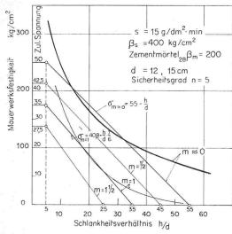
Bild 18. Mittelkurven durch die Versuchspunkte der Mauerwerke von 12 und 15 cm Dicke, hergestellt mit hochwertigen Backsteinen aus verschiedenen Ziegeleien. Steindruckfestigkeit: 400 kg/cm², spezifische Saugfähigkeit: 15 g/dm²min, Mörteldruckfestigkeit nach 28 Tagen: 200 kg/cm², zulässige Spannungen für verschiedene Exzentrizitäten m des Lastangriffspunktes  $\approx$  0, ½, 1 und 1½ in Abhängigkeit vom Schlankheitsverhältnis
