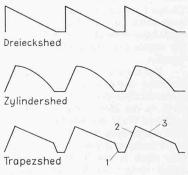
Bild 1. Drei typische Shedformen. Elemente des Trapezshed: 1 V-förmiger Rinnenträger 2 Stahlstützenkonstruktion in den Fensterebenen, 3 Dachplatte
