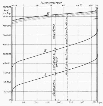
Bild 4. Tägliche Wärmeumsätze in einem Fleischlagerraum von +  $1^{\circ}$  C. 82 % in Abhängigkeit der verschieden warmen Tage des Jahres
