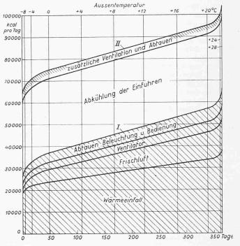
Bild 3. Täglicher Kältebedarf in einer Gemeinschaftstiefkühlanlage bei einer Raumtemperatur von —  $20^{\circ}$  C ohne (Kurve I) und mit Einfuhren (Kurve II) in Abhängigkeit der verschieden warmen Tage des Jahres
