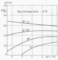
Bild 2. Verhältniswerte  $\Delta x/\Delta I$  in Abhängigkeit der Luftabkühlung im Kühler für drei verschiedene Raumtemperaturen und verschiedene relative Raumfeuchtigkeiten  $\varphi$
