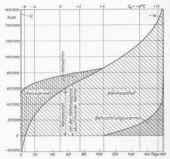
Bild 5. Tägliche Wärmeumsätze in einem Obstlagerraum von  $+4^{\circ}$  C, 92 % in Abhängigkeit der verschieden kalten Tage während der Lagerzeit (1. November bis 30. April)
