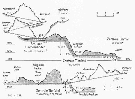
Bild 2. Schematische Längenprofile der Kraftwerkgruppe Linth-Limmern
