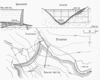
Bild 5. Bogenstaumauer für den Stausee im Limmernboden
