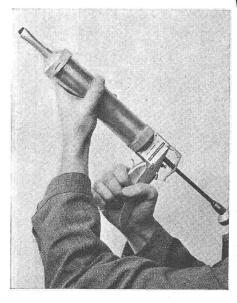
Nerax wird verwendet zum Abdichten von Dilatationsfugen, Fugen zwischen vorfabrizierten Bauelementen, Ueberlappungen bei Well-Eternit- und Wellblechdächern, Muffen von Ablaufrohren.
