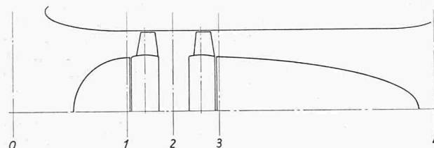
Bild 4. Zwei hintereinander geschaltete, gegenläufige Axialgitter (Hierzu Bild 8)
