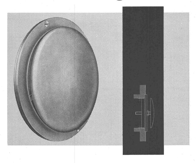
Die gefällige, tellerförmige Form des EVH-Entlüftungs-Ventils erlaubt eine vielseitige, unauffällige Verwendbarkeit. Es ist aus Leichtmetallpressguss hergestellt und wird ohne Anstrich mit unpoliertem Teller geliefert. Spindel und Mutter sind aus Eisen kadmiert.
