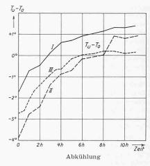
Bild 12. Temperaturunterschiede zwischen Oberfläche und Untersicht einer Lehnenbrücke für drei verschiedene Querschnittspunkte I bis III
