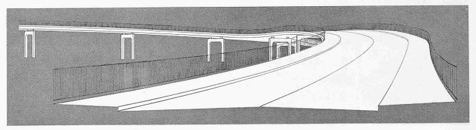
Bild 3. Ueberführungsbauwerk, Studium der Linienführung anhand einer Perspektive
