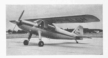
Die Landeklappen lassen sich bis 45° verstellen; sie sind, wie die Querruder, an der Eintrittskante mit einem Doppelspalt versehen und um eine feste Achse innerhalb des Flügelprofils drehbar gelagert. Ruder- und Flossenflächen der Heckleitwerke sind reichlich bemessen; der Rumpf ist verhältnismässig lang. Grosse Fenster geben gute Sicht und erleichtern das Ein- und Aussteigen.
