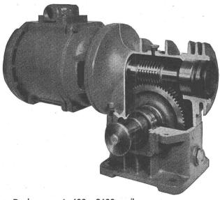
Drehmoment 400—2600 cm/kg Drehzahl 11—104
