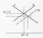
Bild 4. Frequenz-Leistungsregelung von zwei Netzen; Darstellung durch Kennlinien
