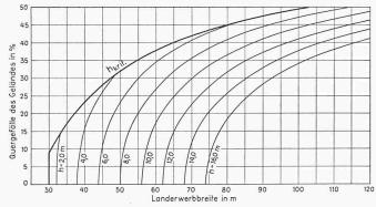
Bild 8. Breite des Landerwerbs in Funktion der Geländequerneigung und der Höhendifferenz h zwischen Strassenaxe und Gelände. Wenn  $h < h_{krit}$ . = 1/2  $b \cdot p$
