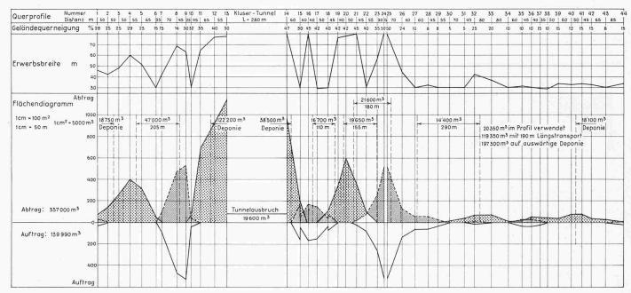
Bild 6. Normal-Längenprofil 1:5000/500 (hier auf 1/2 verkleinert) mit Diagramm der Erwerbsbreite und Diagramm der Massenverteilung
