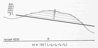
Bild 5. Massenmasstab auf Längenprofil aufgelegt
