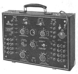
gestellte Vektorvergleichsgerät (siehe Bild) aus der ersten Fabrikationsserie gestattet die Kontrolle von Drehfeld- und Energiefluss-Richtungen, wodurch Schaltfehler in unter Spannung stehenden Haupt- und Hilfsstromkreisen in kürzester Zeit ermittelt werden können.
