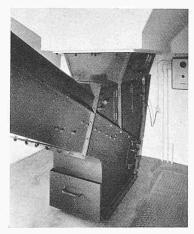
Bild 6. Abzug unter dem Koksbunker. Die Vibrationsrinne und das Förderband sind staubdicht verschalt, Staub und Kleinkorn sammeln sich in der Schublade
