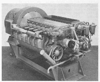
Bild 2. Zwölfzylinder-Boxermotor der SLM
