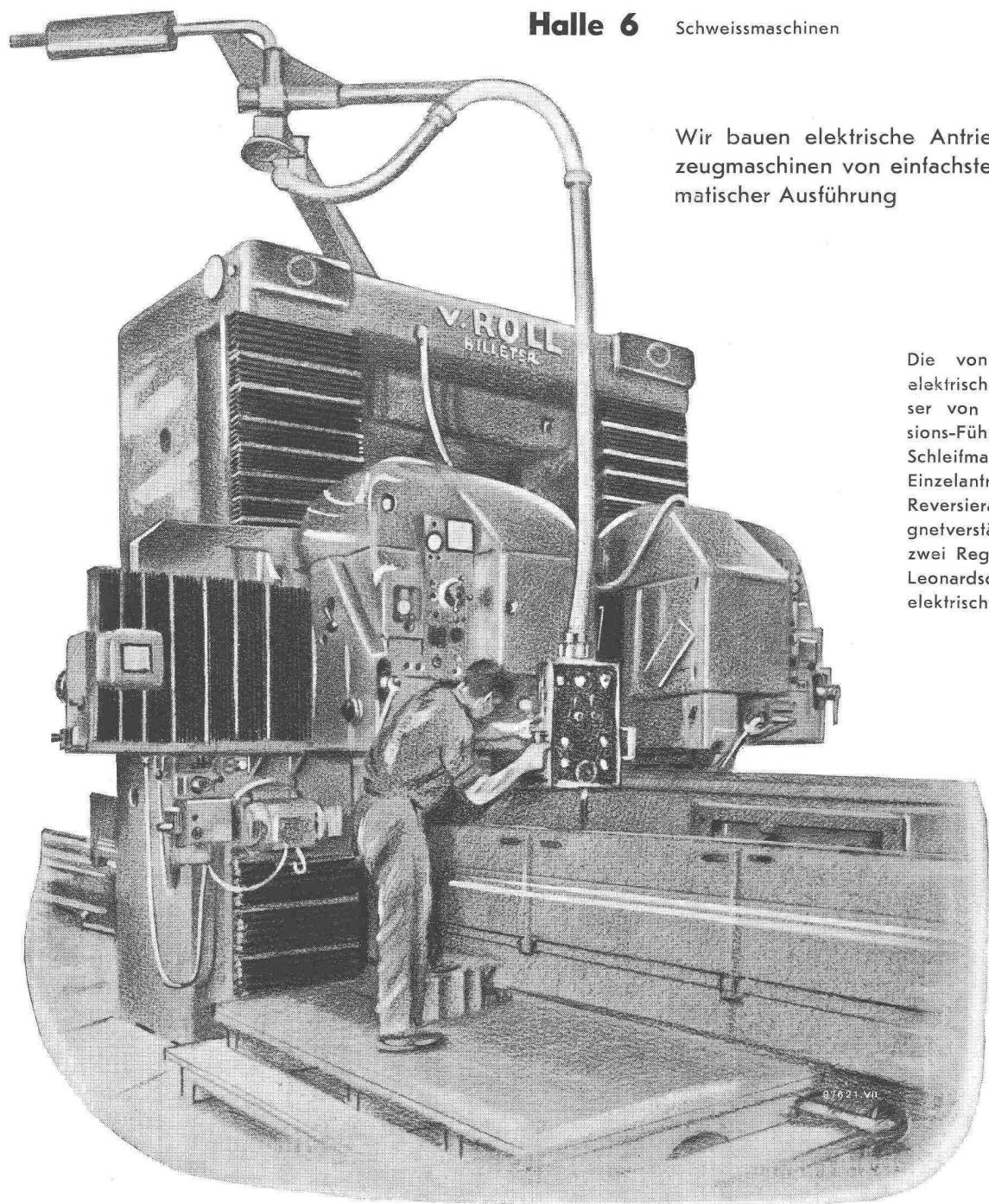
Die von uns gelieferte elektrische Ausrüstung dieser von Rollschen Präzisions-Führungsbahnen-Schleifmaschine umfasst 25 Einzelantriebe, u. a. einen Reversierantrieb mit Magnetverstärker-Steuerung, zwei Regelantriebe in Leonardschaltung und eine elektrische Welle
