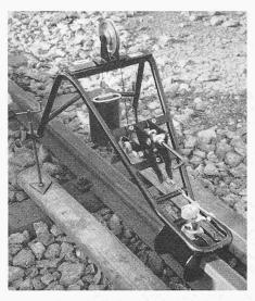
Bild 17. Spannbock für die Invardrahtausrüstung, eingerichtet für die Messung von Strekken längs Eisenbahnschienen
