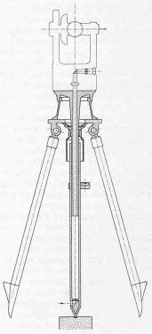
Bild 20. Kugelgelenk-Zentrierstativ von Kern (Aarau) mit besonderer Einrichtung zur sehr genauen Zentrierung auf Zehntel-Millimeter. Eine ähnliche Einrichtung besteht auch für das Kippteller-Stativ
