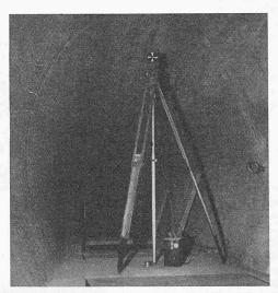
Bild 24. Zielmarke auf speziellem Zentrierstativ
