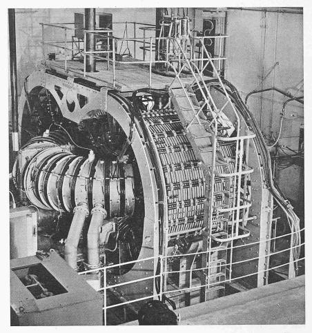
Bild 1. Gesamtansicht der «Zeta»-Apparatur im Atomic Energy Research Establishment in Harwell der United Kingdorn Atomic Energy Authority
