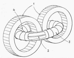
Bild 2. Schema der Wicklungen zum Erregen der magnetischen Felder bei der Zeta-Apparatur.
