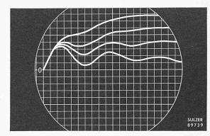
Bild 3. Gasturbinenanlage Hainaut (Belgien), Drehzahlverlauf bei verschiedenen Regelgeschwindigkeiten
