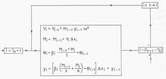
Bild 2. Ausschnitt aus dem Flussdiagramm zur Berechnung der kritischen Drehzahlen
