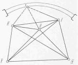
Bild 2. Einfache Form eines Pfeilernetzes mit drei vordern (Beobachtungs-) und zwei hintern (Versicherungs-)pfeilern
