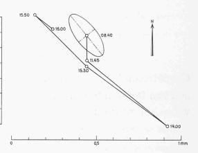
Bild 4. Kurzfristige Verschiebungen eines Beobachtungspfeilers
