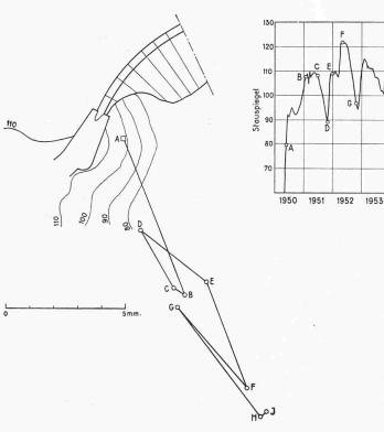
Bild 3. Langfristige Verschiebung eines Beobachtungspfeilers in der Nähe einer Staumauer (Portugal)
