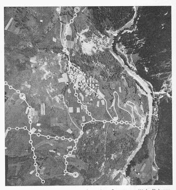
Bild 15, Verschiebungsmessungen im untern Lungnez mittels Polygonzügen. In Bildmitte Peiden, rechts Peidenbad (vgl. Bild 10)
