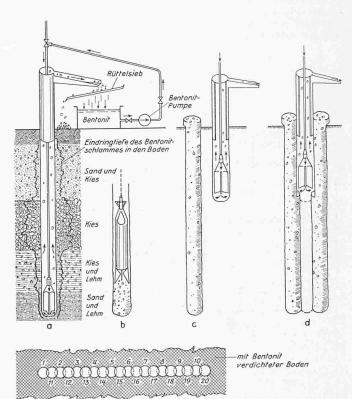
Bild 1. Herstellung von Bentonitpfählen und Bentonitdiaphragmen
