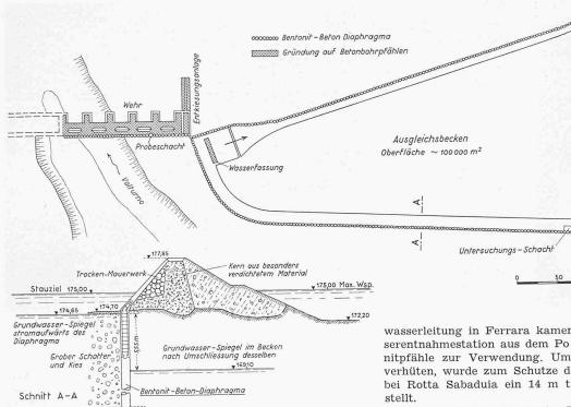
Bild 5. Ausgleichsbecken mit Wasserfassung am Volturno des Kraft-«Rocca d'Evandro» der Società Meridionale di Elettricità (Napoli), 1:5000. Abdichtung mit Bentonit-Diaphragma
