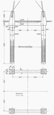
Bild 2. Mastfundament der 225 - kV - Leitung Cavergno-Avegno auf 4 Bentonitpfählen in der Maggia, 1:250
