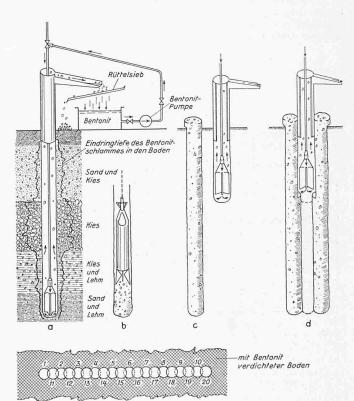
Bild 1. Herstellung von Bentonitpfählen und Bentonitdiaphragmen
