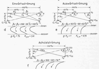
Bild 2. Geschwindigkeitsdreiecke für Kompressorstufen
